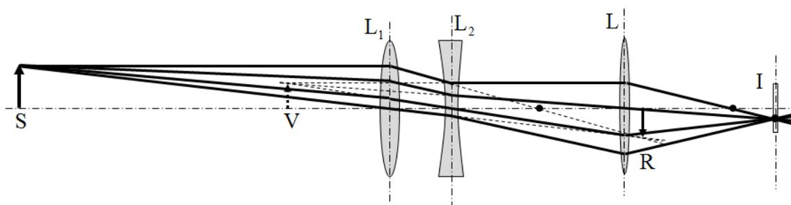
この図は、 $S$  で表した被写体(光源)をテレコンを用いて撮影している例です。この場合の光路を書くためには、まず、 $L_1$  レンズで  $S$  の実像を  $R$  に作ることを考えます。図では、実線は実際に光が通る光路を表し、破線は仮想的な線を表します。すべての光路を描くと図が複雑になってしまうので、実線については必要な部分だけを抜き出して描くと次のような図になります。
