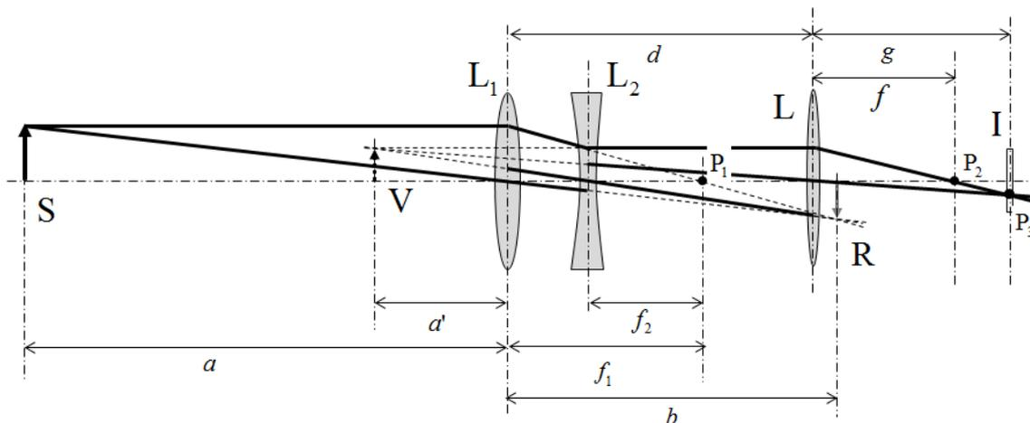
光源  $S$  の先端から出た光線のうち、実像を考えるのに必要な光線は、軸に平行な光線と、凸レンズ  $L_1$  の中心を通る光線です。この2本の線によって、実像  $R$  の位置を特定することができます。一方、軸に平行な光線は、凹レンズ  $L_2$  の作用で再び平行光線になり、カメラレンズ  $L$  に入射し、焦点位置  $P_2$  を通り、撮像素子上に焦点  $P_3$  を結びます。
