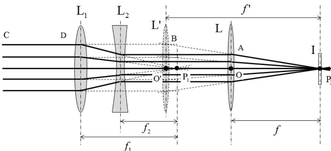
フロントコンバーターは凸レンズと凹レンズの組み合わせでできています。例えば、上の図のレンズ  $L_1$  と  $L_2$  の組み合わせがそれに当たります。このとき、2つのレンズの焦点位置を一致するようにすると、平行光線が凸レンズ  $L_1$  に入射すると、その焦点位置  $P_1$  に収束するように曲がりますが、凹レンズ  $L_2$  があるために再び平行光線になって出力します。つまり、テレコンは平行光線をビーム径を変えて再び平行光線として出力するレンズ系なのです。テレコンを覗くと景色がそのまま見えますが、その大きさが少し大きくなっています。つまり、テレコンはそれ自身では焦点を結ばない光学系なのです。
