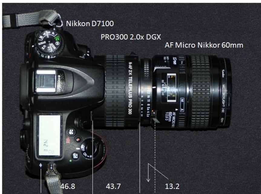
これはテレコンバーターを実際のカメラに装着したところです。各部の寸法はノギスでおおよそ測ってみました。違っているかもしれません。カメラボディの先端からイメージセンサまでの距離は 46.8 mm、テレコンバーターの厚みは 43.7 mm、それに主レンズで焦点を無限遠に合わせたときの見かけの凸レンズの位置がレンズの終端から  $60-46.8=13.2$  mm の位置です。これらの数値を使ってまず、 $b$  の値を推定してみます。無限遠に合わせたときの  $l$  は  $l = f_1 - b/m$  で表されます。したがって、
