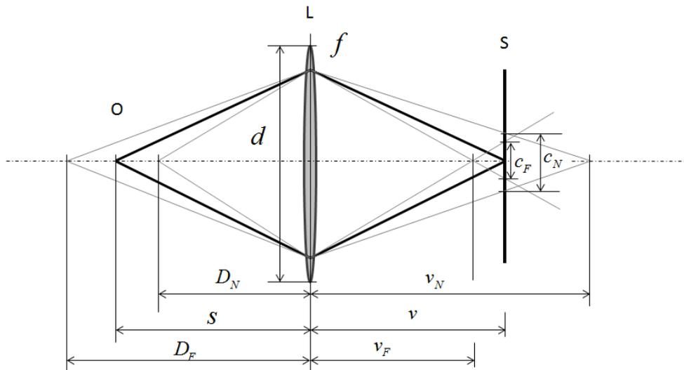
まず、上図のような光学系を考えてみましょう。点Oにある点光源から出た光を焦点距離 $f$ のレンズLでスクリーンS上に集光させることを考えます。もちろん、ここでいうスクリーンはカメラの撮像素子のことです。今、点光源とレンズの距離を $s$ としたときに、点光源から出た光がちょうどスクリーンS上に集光されるとしましょう。このとき、点Oより少し遠い、距離 $D_F$ のところに置いた点光源から出た光は少し手前で集光されます。従って、スクリーン上で像はボケてしまいます。そのボケの大きさを $c_F$ としておきます。同様に、点Oより少し近い、距離 $D_N$ のところに置いた点光源から出た光は、スクリーンより少し後ろ側で集光され、スクリーン上ではやはり像はボケます。その大きさを $c_N$ とします。
