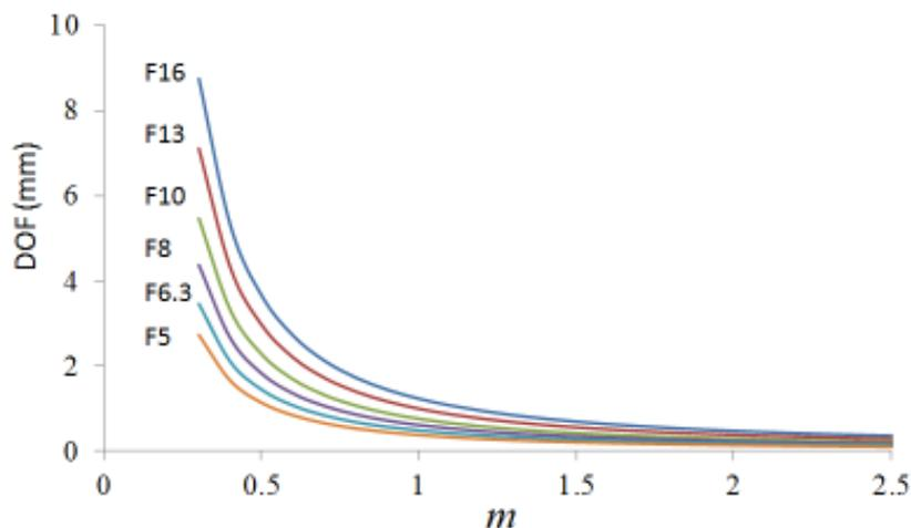
上図は  $c$  を  $0.0189 \text{ mm}$  としていろいろな  $F$  値で式(14)を計算したものです。絞りを絞って  $F$  値を大きくすればするほど、それに比例して被写界深度  $DOF$  は大きくなり、また、倍率  $m$  が大きくなればなるほど、被写界深度は小さくなっていくことが分かります。いずれにしても、等倍 ( $m=1$ ) では  $DOF$  は  $1 \text{ mm}$  程度と大変狭くなってしまいます。許容錯乱円は写真を対角  $30 \text{ cm}$  ほどに引き伸ばしたときの条件ですから、 $L$  版で見るだけならば、対角線の距離は半分程度になりますので、被写界深度も倍になる勘定です。
